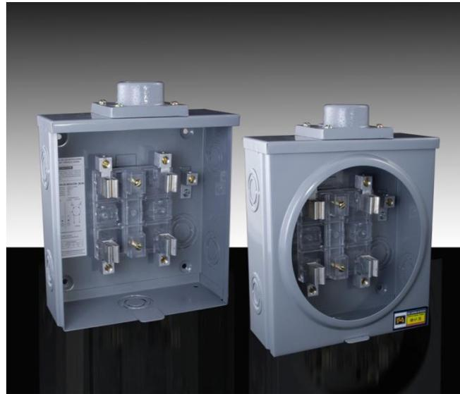
La Base Cuadrada de Medición de 4 mordazas, 100 A, está diseñada para realizar la conexión de la acometida de la compañía que suministra la energía eléctrica y la instalación del equipo de medición (wathhorímetro), así como la conexión de ésta a los equipos de distribución (interruptor de seguridad, centro de carga, tablero de alumbrado, etc.) en instalaciones residenciales o comerciales.
