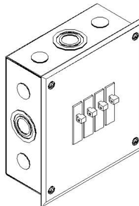
El Centro de Carga de 4 Circuitos, constructora para Interruptores Termomagnéticos de ¾ Tipo Enchufable, está diseñado para la protección y distribución de cargas monofásicas o bifásicas de baja tensión. Se recomienda para instalaciones residenciales, edificios y aplicaciones comerciales ligeras.
